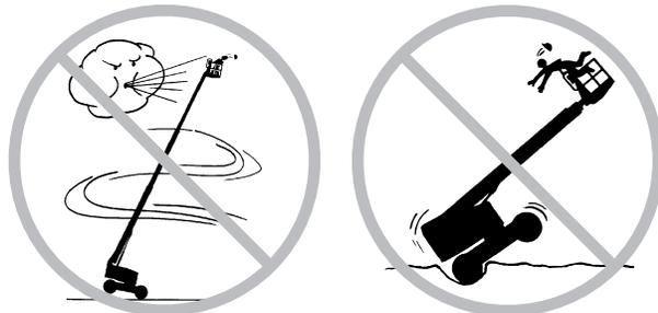
在收起状态下，当机器在不平坦的地带、有碎石、不稳定或光滑的表面、靠近洞口和陡坡等处行驶时，要极其小心并降低速度。
