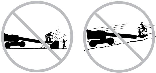
根据地面状况、拥塞程度、坡度、人员位置和可能引起碰撞的任何其它因素，限制行进速度。
